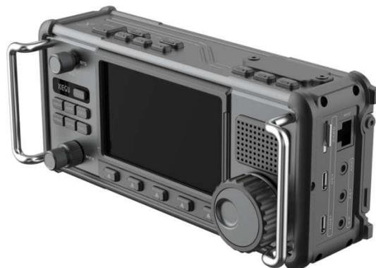
La plate-forme DRFS haute performance propose des fonctions comparables à celles des ordinateurs de bureau, telles que la télécommande, la bande variable, le filtre numérique de largeur, la réduction numérique du bruit, etc.
