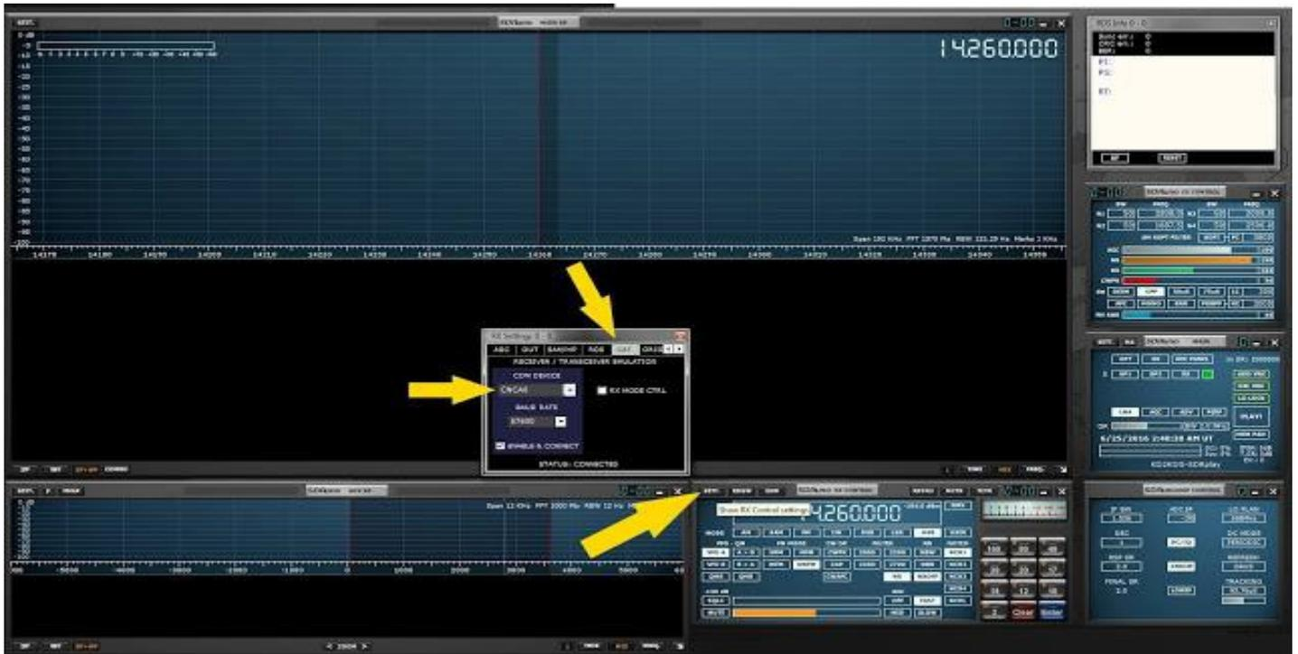
**Étape 1** : Note de la com0com deux ports virtuels créés à partir de la section étape 3 A. Mine juste pour arriver à CNCA0 & CNCB0. Ouvrez SDRuno et aller à votre Module de contrôle RX SDRuno et cliquez sur le bouton du haut gauche appelé « SETT. » Une nouvelle fenêtre pop-up s'ouvre.
