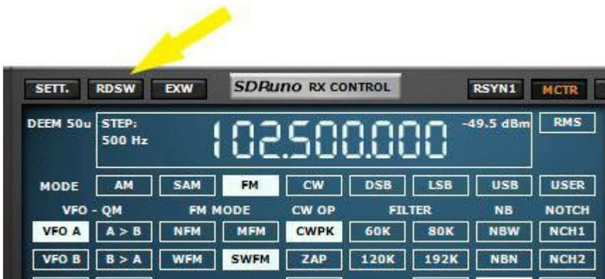
En cliquant sur le bouton RDSW fera apparaître la fenêtre de décodage RDS
