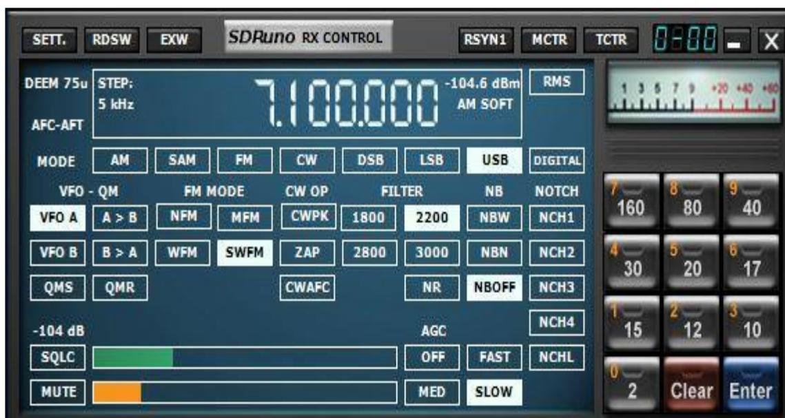
Il peut sembler compliqué, mais c'est assez simples, Standard des contrôles pour le VFO A / B, Modes, filtres, S - mètre, bande de boutons, AGC, silencieux, Volume, Notch.
