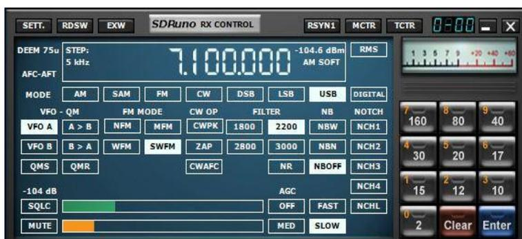
3. Cliquez sur la zone de **RX**, cela va ouvrir la fenêtre de RX, où nous avons mis les fréquences et les modes et quelques objets plus comme filtre de bande passante.
