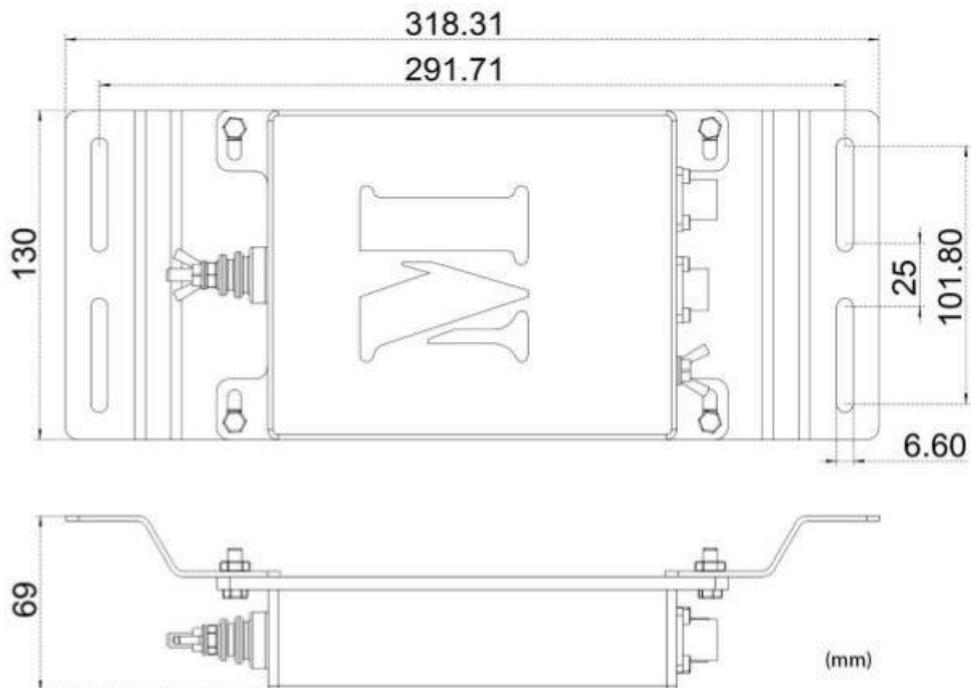
**Dimensions d'installation des tuners avec les supports de montage**
